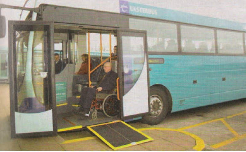
Fotoğraf 21: Alçak zemine rampa erişimi sağlayan yüksek tabanlı yolcu otobüsü.
